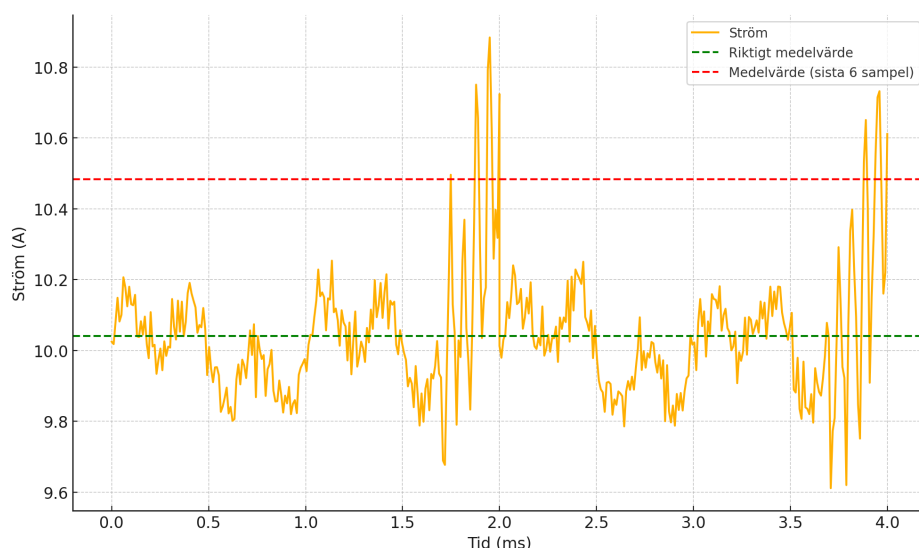
Figur 11: Illustration av hur ECU:n beräknar motorströmmen utifrån ett medelvärde av sampelvärden mot slutet av varje driftcykel. Den röda linjen visar den beräknade strömmen (baserat på sex sista sampel i detta exempel), medan den gröna linjen visar det faktiska medelvärdet över hela cykeln. Tidsintervallet 0–2 ms representerar en driftcykel, följt av ett nytt steg. Skillnaden mellan de två kurvorna illustrerar överskattningen i det rapporterade värdet. Figuren är inte baserad på verkliga mätdata, utan är en schematisk och något överdriven visualisering för att tydliggöra principen.
